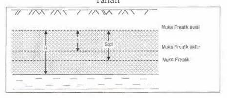
Sopt= penurunan Muka Air Tanah akibat pengambilan Air Tanah dengan debit optimum
