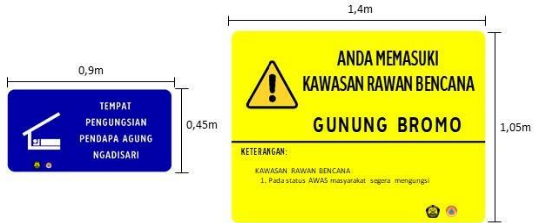
Gambar. Contoh Papan Informasi Penanda Tempat Lokasi Pengungsian (kiri: ukuran 0,9 m x 0,45 m) dan Papan Informasi memasuki Kawasan Rawan Bencana (kanan: ukuran 1,4m x 1,05 m) di Destinasi Pariwisata Prioritas Bromo-Tengger-Semeru, Provinsi Jawa Timur
