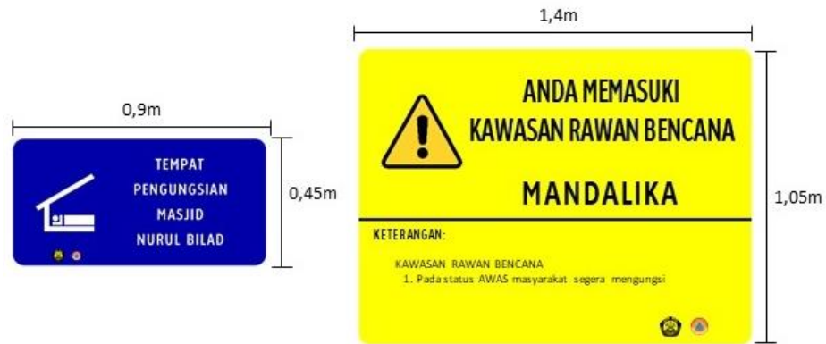
Gambar. Contoh Papan Informasi Penanda Tempat Lokasi Pengungsian (kiri: ukuran 0,9 m x 0,45 m) dan Papan Informasi memasuki Kawasan Rawan Bencana (kanan: ukuran 1,4m x 1,05 m) di Destinasi Super Prioritas Mandalika, Kabupaten Lombok Tengah, Provinsi Nusa Tenggara Barat
