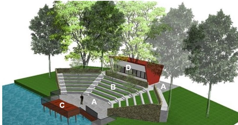
A. Plaza Amfiteater; B. Amfiteater; C. Panggung Kesenian; D. Bangunan (Ruang ganti/ruang tunggu, Ruang Kontrol, dan Gudang)
