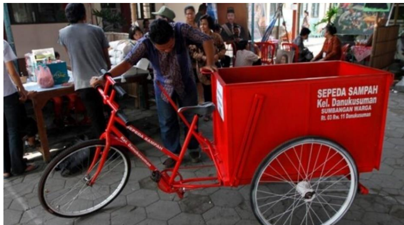
Gambar. Contoh Ilustrasi Panduan Visual Kendaraan Pengumpul Sampah Tipe Sepeda dengan Bak Sampah Besar di Kawasan Wisata Perdesaan dan Desa Wisata
