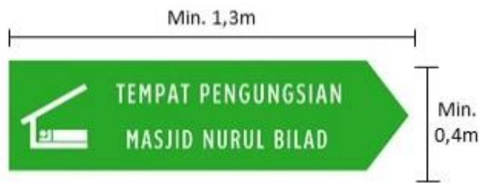
Gambar. Contoh Ilustrasi Panduan Visual Perancangan Rambu Bencana dengan Kata (ukuran min 1,3 m x 0,4 m) di Destinasi Super Prioritas Mandalika, Kabupaten Lombok Tengah, Provinsi Nusa Tenggara Barat.
