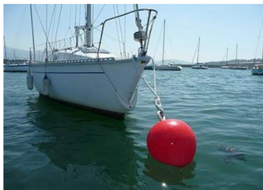
Gambar. Contoh Ilustrasi panduan visual Tambat Apung ( Mooring Buoy ) Tipe Satu (Diameter 343mm, Berwarna Merah atau Jingga)
