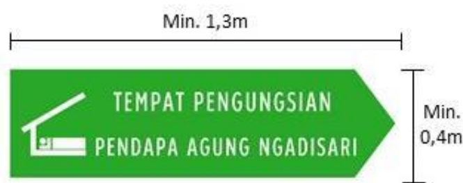
Gambar. Contoh Ilustrasi Panduan Visual Perancangan Rambu Bencana dengan Kata (ukuran min 1,3 m x 0,4 m) di Destinasi Pariwisata Prioritas Bromo-Tengger-Semeru, Provinsi Jawa Timur
