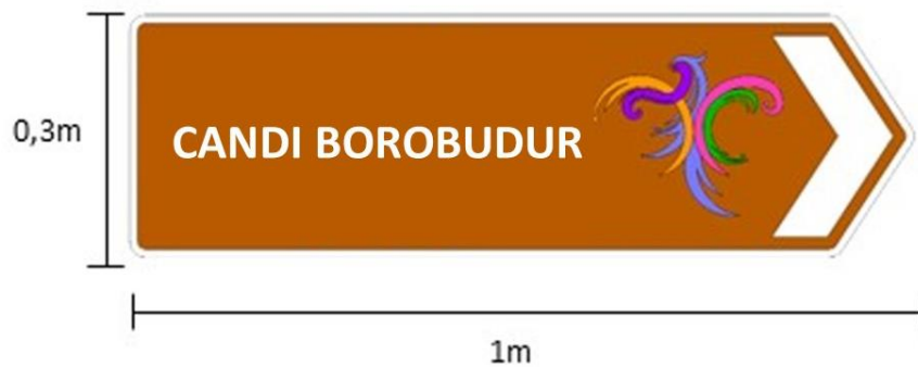
Gambar. Contoh ilustrasi panduan visual perancangan rambu petunjuk arah ( signage ) di Kawasan Wisata Budaya dan Perkotaan Destinasi Super Prioritas Borobudur dan sekitarnya, Provinsi Jawa Tengah
