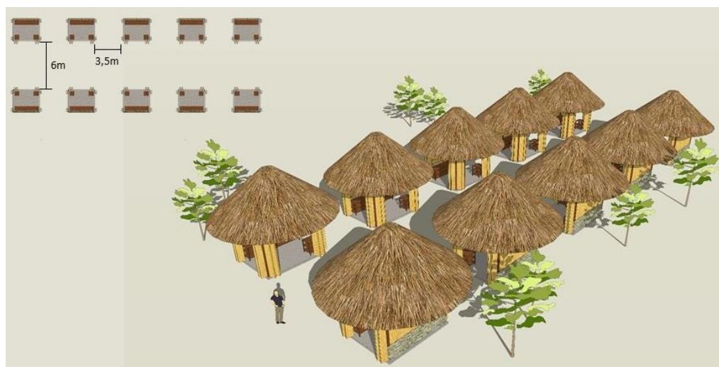
Gambar. Contoh ilustrasi panduan visual perancangan Kios Cendera Mata yang berkelompok (10 unit) pada Kawasan Wisata Bahari dan Perairan di Destinasi Super Prioritas Labuan Bajo, Pulau Flores, Provinsi Nusa Tenggara Timur
