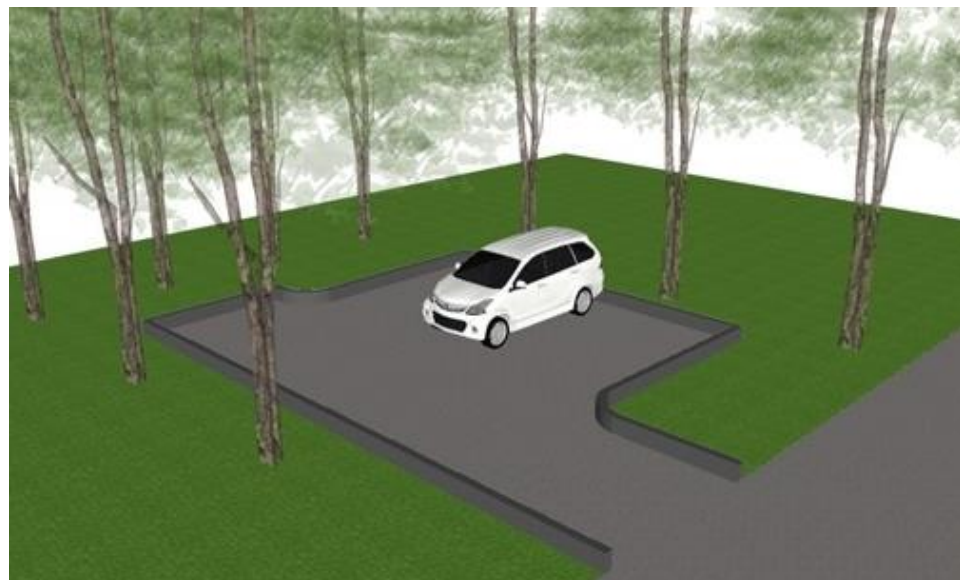
Gambar. Contoh Ilustrasi Panduan Visual Perancangan Tempat Parkir Tipikal (Tiga Modul Parkir Mobil dan Jalur Sirkulasi Parkir Satu Jalur).
