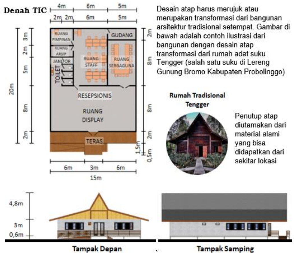
Gambar. Contoh Ilustrasi Panduan Visual Perancangan TIC (Tourism Information Center/Pusat Informasi Pariwisata) bangunan satu lantai (luas 300 m 2 ) dengan kantor pengelola di Kawasan Wisata Alam (Nonbahari) Bromo-Tengger-Semeru, Provinsi Jawa Timur
