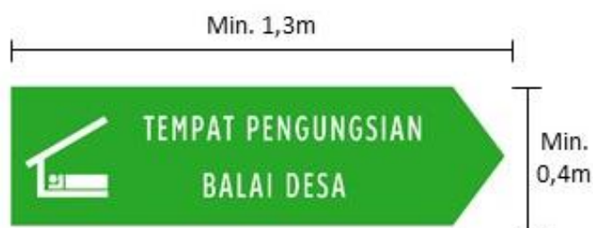
Gambar. Contoh Ilustrasi Panduan Visual Perancangan Rambu Bencana dengan Kata (ukuran min 1,3 m x 0,4 m) Kawasan Wisata Perdesaan dan Desa Wisata di Kabupaten Gianyar, Provinsi Bali
