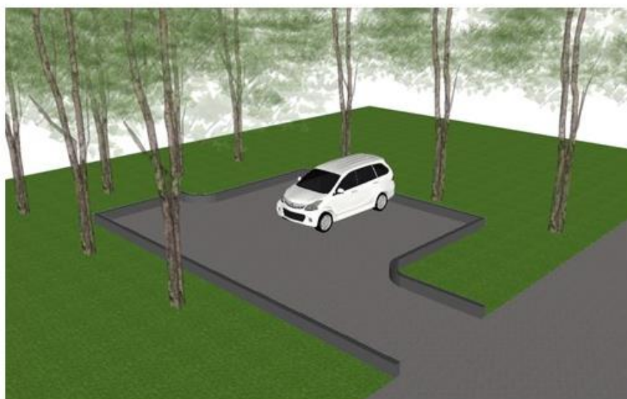
Gambar. Contoh Panduan Visual Perancangan Tempat Parkir Tipikal (Tiga Modul Parkir Mobil dan Jalur Sirkulasi Parkir Satu Jalur).
