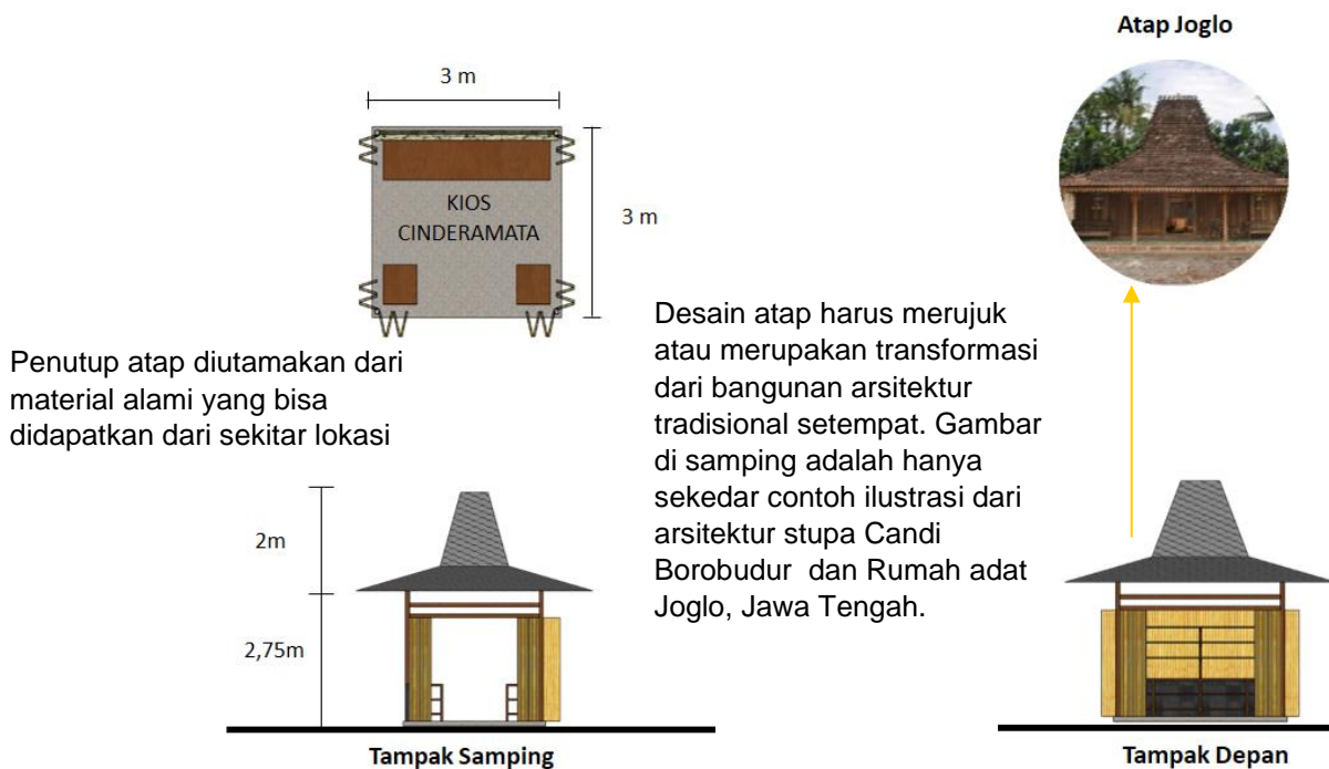
Gambar. Contoh Ilustrasi Panduan Visual Perancangan Kios Cendera mata (satu unit) yang akan ditata pada suatu area di Area Terbuka Pariwisata Kawasan Borobudur dan sekitarnya, Kota Magelang, Provinsi Jawa Tengah.
