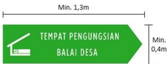
Gambar. Contoh Ilustrasi Panduan Visual Perancangan Rambu Bencana (contoh Rambu Petunjuk Bencana dengan Kata ukuran min 1,3 m x 0,4 m) di Kawasan Pedesaan di Kabupaten Gianyar, Provinsi Bali.
