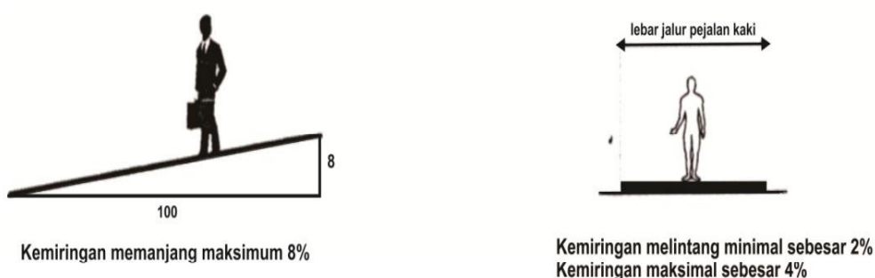
Gambar. Ilustrasi Kemiringan Jalur Pejalan Kaki (Pedestrian)
