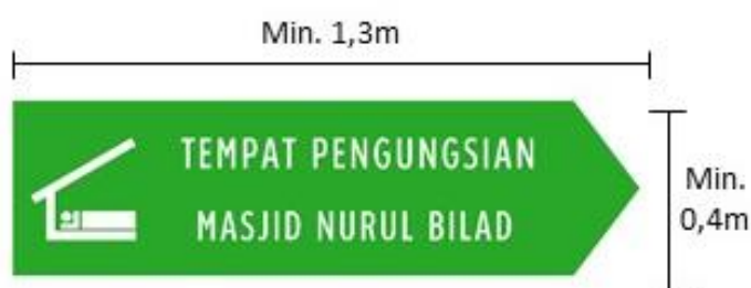
Gambar. Contoh Ilustrasi Panduan Visual Perancangan Rambu Bencana (contoh Rambu Petunjuk Bencana dengan Kata ukuran min 1,3 m x 0,4 m) di Kawasan Dermaga Wisata Mandalika, Kabupaten Lombok Tengah, Provinsi Nusa Tenggara Barat.
