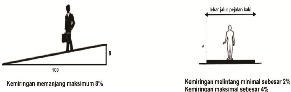
Gambar. Ilustrasi Kemiringan Jalur Pejalan Kaki (Pedestrian)
