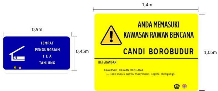
Gambar. Contoh Ilustrasi Panduan Visual Perancangan Papan Informasi Bencana (contoh papan informasi memasuki kawasan rawan bencana - kanan (ukuran 1,4m x 1,05 m) dan papan informasi penanda tempat lokasi pengungsian – kiri (ukuran 0,9mx0,45m) di Kawasan Area Terbuka Pariwisata Kawasan Borobudur dan sekitarnya)
