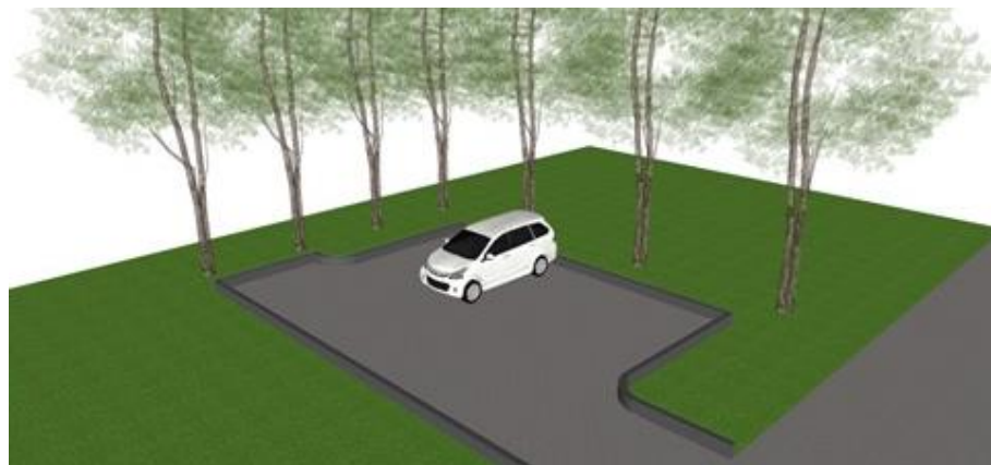
Gambar. Contoh Panduan Visual Perancangan Tempat Parkir Tipikal (Tiga Modul Parkir Mobil dan Jalur Sirkulasi Parkir Satu Jalur).
