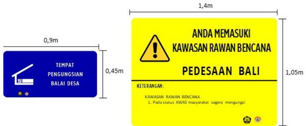
Gambar. Contoh Ilustrasi Panduan Visual Perancangan Papan Informasi Bencana (contoh papan informasi memasuki kawasan rawan bencana - kanan (ukuran 1,4m x 1,05 m) dan papan informasi penanda tempat lokasi pengungsian – kiri (ukuran 0,9mx0,45m) di Kawasan pariwisata Pedesaan di Kabupaten Gianyar, Provinsi Bali.
