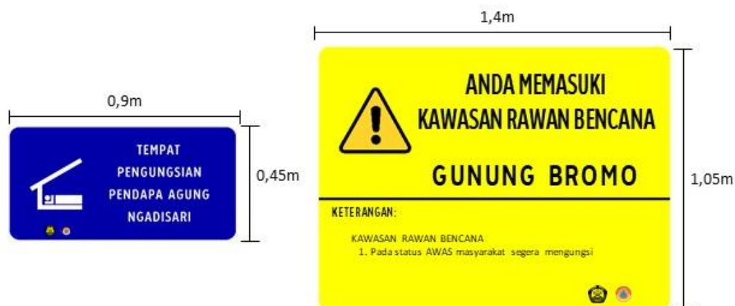
Gambar. Contoh Ilustrasi Panduan Visual Perancangan Papan Informasi Bencana (contoh papan informasi memasuki kawasan rawan bencana - kanan (ukuran 1,4m x 1,05 m) dan
