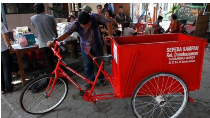
Gambar. Contoh Ilustrasi Panduan Visual Contoh Kendaraan Pengumpul Sampah Tipe Sepeda dengan Bak Sampah Besar di Kawasan Pariwisata
