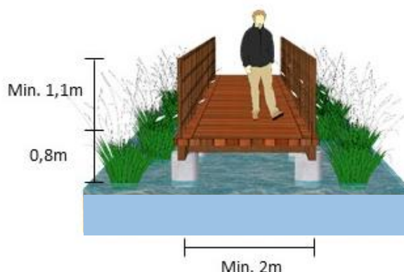
Gambar. Contoh Ilustrasi Panduan Visual Perancangan Boardwalk di Kawasan Track Wisata Alam
